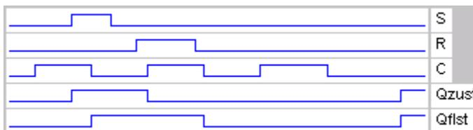
Das Impulsdiagramm zeigt das unterschiedliche Verhalten der Ausgänge Q eines RS-Latch und eines RS-Flip-Flop (negative Flanke). Der Ausgang des Latch übernimmt das Signal S sofort, wenn der Zustand von C log.1 ist. Der Ausgang des Flip-Flop (getriggert auf negative Flanke) übernimmt das Signal von S erst, wenn der Taktzustand von log.1 nach log.0 wechselt.
